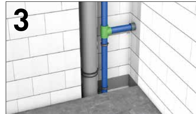
Duvar geçişlerinde kılıf borusunun büyük boyutlandırılması
