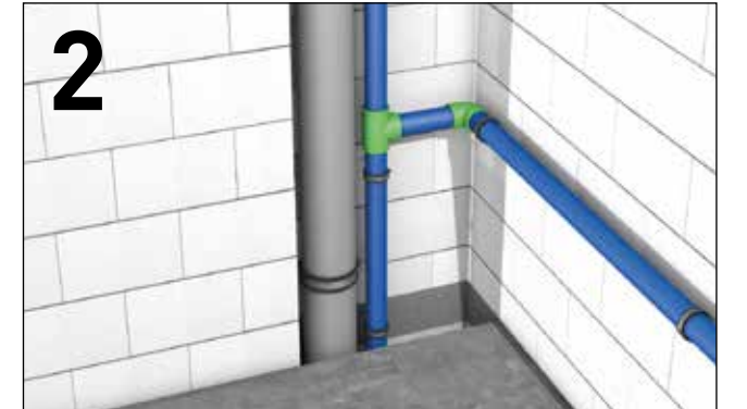
Kolonun şaft içine uygun yerleşimi
